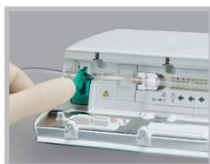
3. Engager le clamp anti-écoulement dans son logement en le poussant dans le sens de la flèche, jusqu'à ce que le levier d'ouverture se verrouille et que le clamp de sécurité pince la tubulure.
