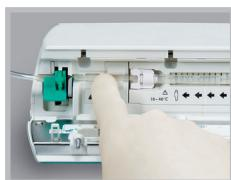
4. Enfoncer fermement la tubulure dans le guide des capteurs d'air pour faire en sorte que la ligne soit convenablement insérée dans les capteurs.
