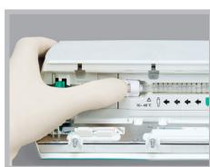
2. Ensuite, fixer le clip blanc. S'assurer que le segment en silicone n'est pas étiré ou vrillé. Les étoiles sur la tubulure doivent former une ligne droite.
