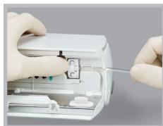
1. Insérer la tubulure de la droite vers la gauche. Disposer d'abord la tubulure dans le capteur amont, puis insérer le clip percé de deux trous.
